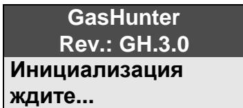
На экране покажется название измерителя, а также актуальная версия программного обеспечения. Во время высвечивания заставки осуществляется инициализация работы измерителя. Примерно через десять секунд заставка исчезнет, прибор перейдёт в измерительный режим и к отображению мгновенных значений. На экране появятся наименования измеряемых медиум и показатель уровня зарядки батареи питания.
