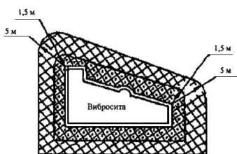
Рис.4. Открытые пространства вокруг открытых емкостей, аппаратов, устройств
